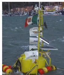
Per garantire l'autonomia funzionale degli apparati di bordo Sea\_Lab ospita opportune batterie (posizionate nella deriva) che vengono alimentate da pannelli a celle fotovoltaiche.
